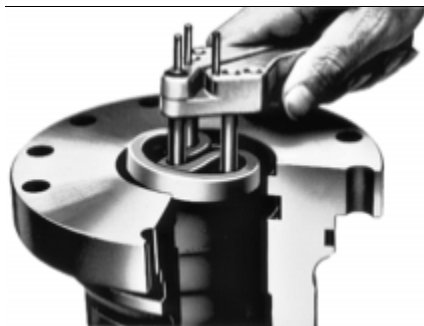
Рис. 4.24 Монтажный инструмент I для уплотнений штока
