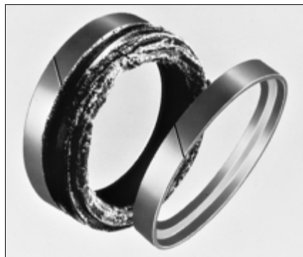
Рис. 4.18 Экструзивный износ компактного поршневого уплотнения
