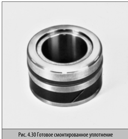
Рис. 4.30 Готовое смонтированное уплотнение
