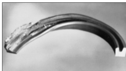
Рис. 4.12 Манжета, разрушенная из-за гидродинамического роста давления
